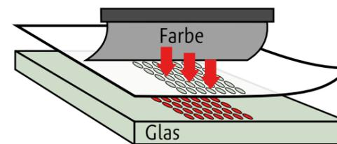
Siebdruckgläser erfordern einen erhöhten Fertigungsaufwand, da für jedes Motiv ein eigenes Sieb gefertigt werden muss. Durch ein spezielles Verfahren wird die Farbe durch das Sieb (Siebdruckfolie) auf das Glas aufgebracht.
