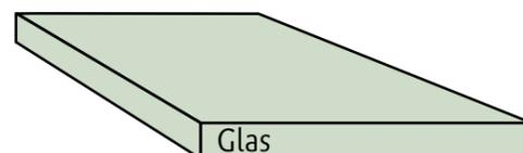
ESG-Glas (Einscheiben-Sicherheitsglas) besteht aus 1 Scheibe, die speziell wärmebehandelt ist. Durch diese Wärmebehandlung wird das Glas stark erhitzt und schlagartig abgekühlt. Durch diese sog. "Vorspannung" entstehen beim Bruch der Scheibe viele kleine Bruchstücke und keine großen scharfkantigen Glasscherben.
