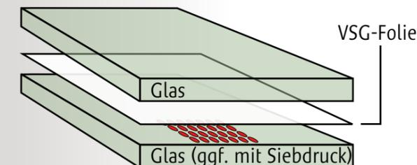
Dieses Glas stellt einen Verbund von 2 Glasscheiben dar, die durch eine reißfeste und zähelastische Folie verbunden werden. Das Motiv (Siebdruck) befindet sich zwischen beiden Scheiben, bietet dadurch eine hohe Stabilität und ist pflegeleicht. **Auch Digitaldruck möglich.**
