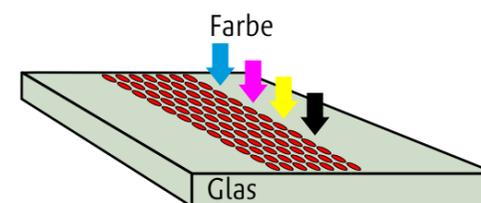
Die Farben/das Motiv werden digital auf das Glas gedruckt und bieten eine hohe Druckauflösung. Das Glas ist sehr kratz- und UV-beständig und kann mit eigenen Wunschmotiven bedruckt werden.
